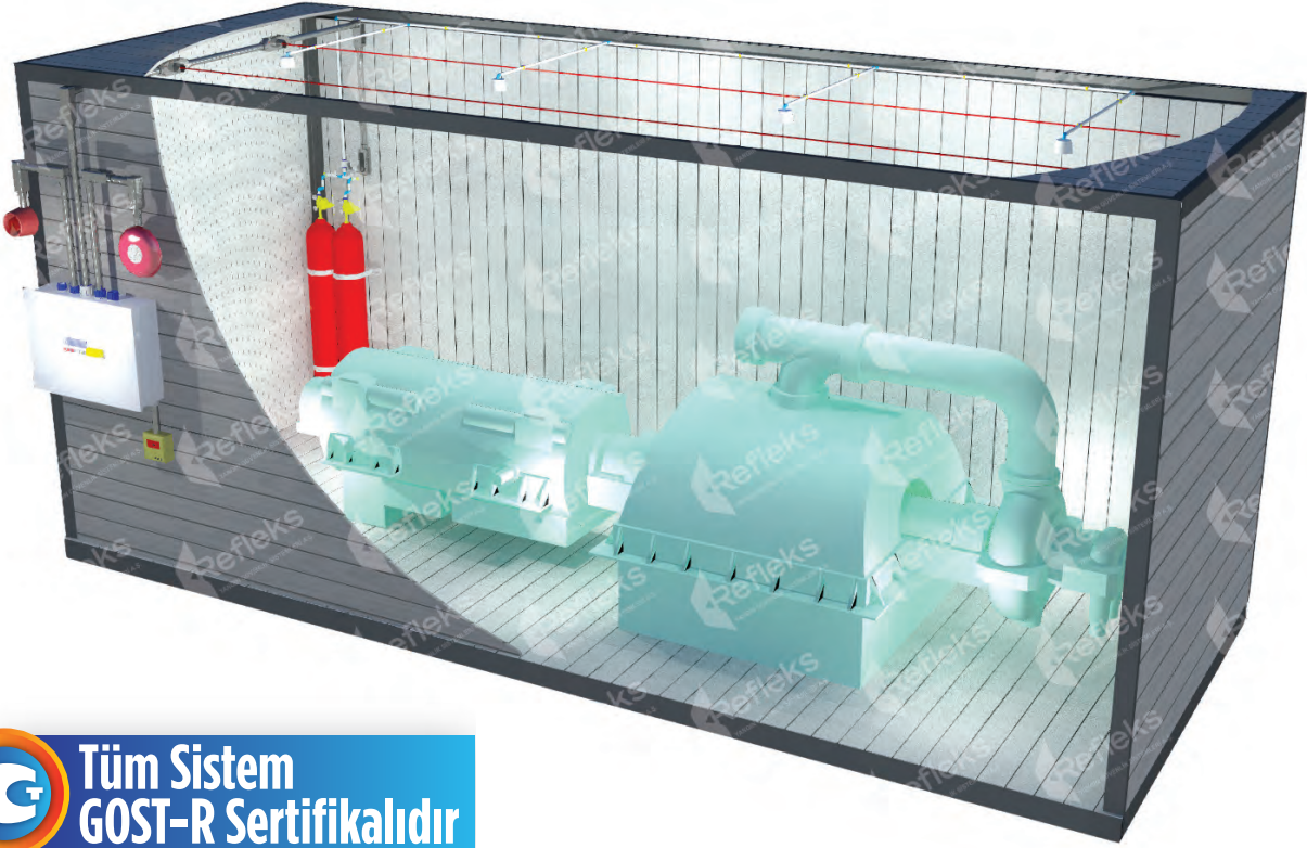
Konteyner CO 2 Gazlı Söndürme Uygulaması
